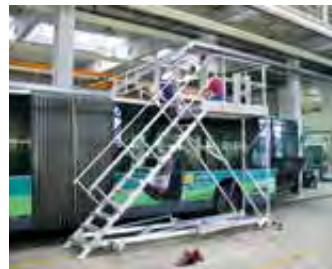
Schnell und garantiert sicher: Wartungsbühne mit Zentralfeststellung
