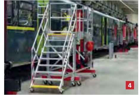
4. Mobile Seitenarbeitsbühne zum Bearbeiten der unteren Seitenbereiche
