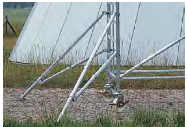
9521 mit Auslegern ab einer Arbeitshöhe von 8,30m
