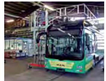
Robuste Einhausung: Mit Ausklappgeländer für zusätzlichen Schutz
