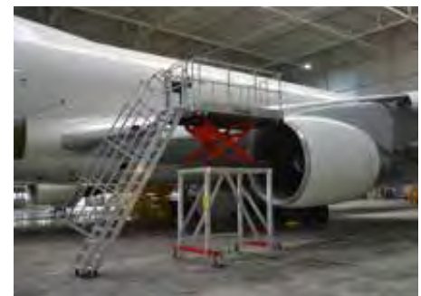
Hydraulisch höhenverstellbare Wartungsbühne
