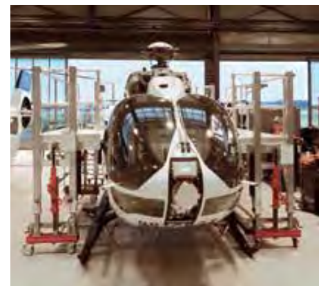
Mobile Hubschrauberbühne mit Variotreppe als schnell einsatzbereite Wartungseinheit
