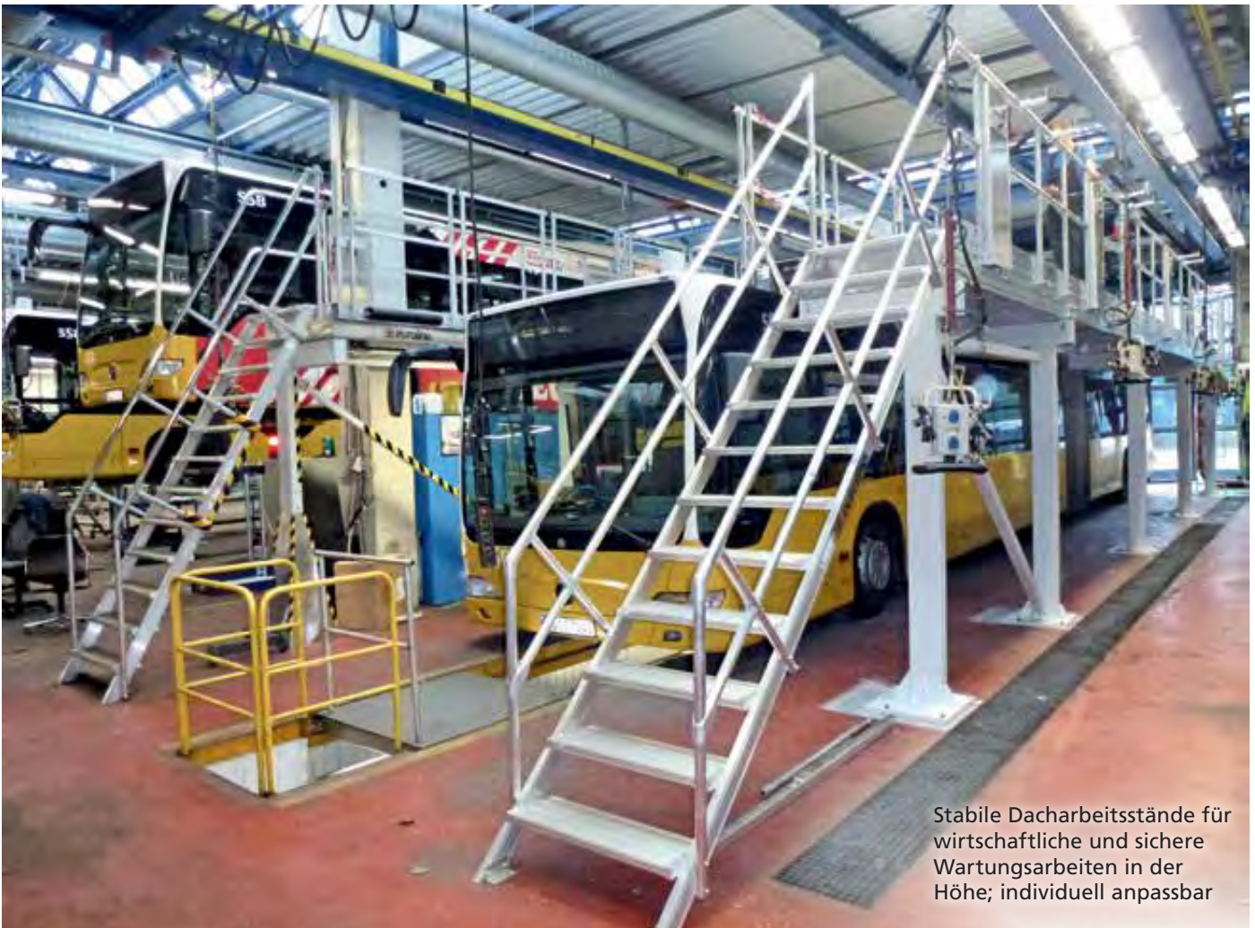
Schnell und garantiert sicher: Wartungsbühne mit Zentralfeststellung
